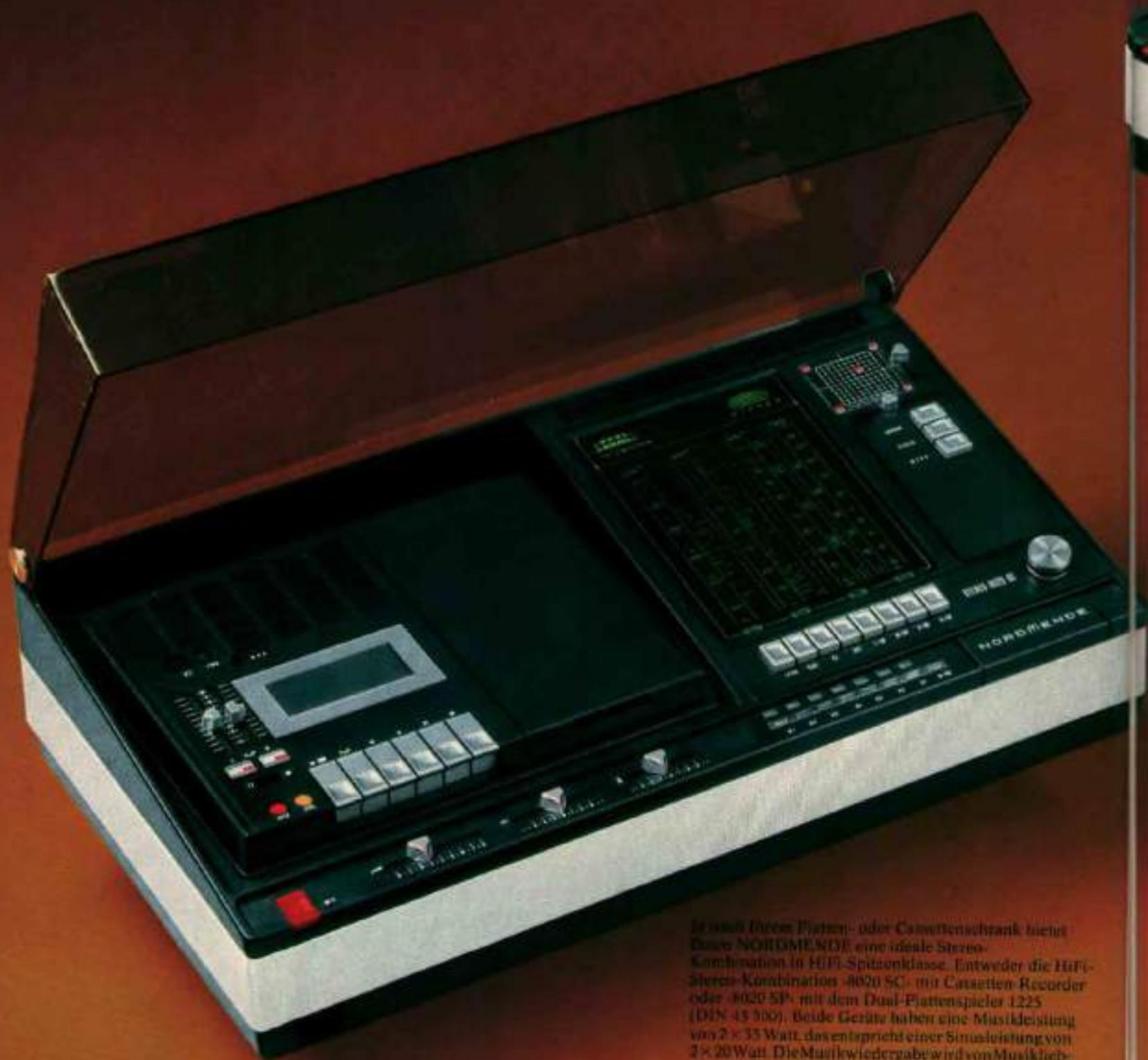
In your HiFi-Platten- oder Cassettenschrank bietet Ihnen NORDMENDE eine ideale Stereo-Kombination in HiFi-Spitzenklasse. Entweder die HiFi-Stereo-Kombination 4020 SC mit Cassetten-Recorder oder 4020 SP mit dem Dual-Plattenspieler 1225 (DIN 45 300). Beide Geräte haben eine Musikleistung von 2 x 35 Watt, das entspricht einer Sinusleistung von 2 x 20 Watt. Die Musikwiedergabe wird von Musikliebhabern wegen der natürlichen Klangfülle und greifbaren Räumlichkeit hoch geschätzt.
