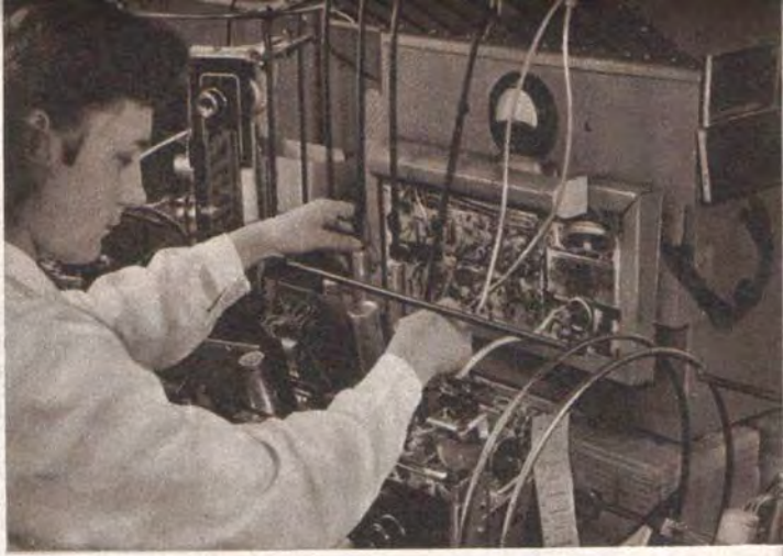
Dieses automatische Kontrollgerät-Adapter-führt an jedem fertig montierten Rundfunk-Chassis in einem Arbeitsgang 30 Prüfungen durch.
