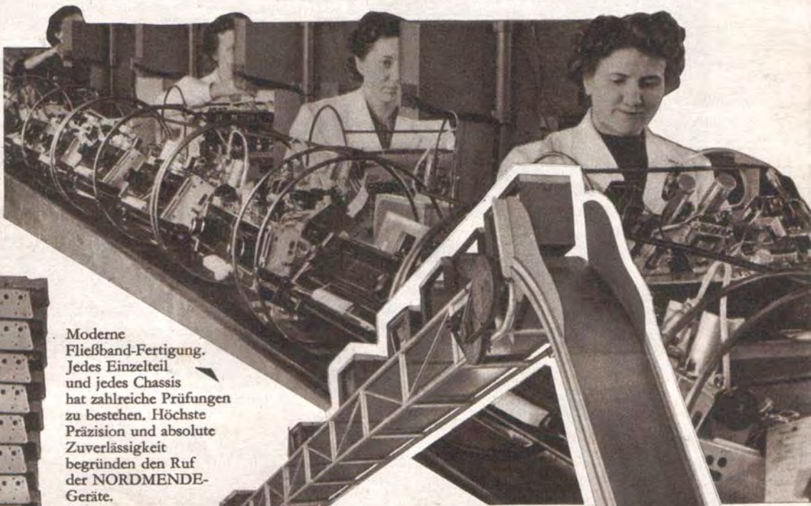
Dieses automatische Kontrollgerät-Adapter-führt an jedem fertig montierten Rundfunk-Chassis in einem Arbeitsgang 30 Prüfungen durch.
