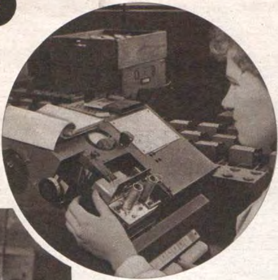
Dieses automatische Kontrollgerät-Adapter-führt an jedem fertig montierten Rundfunk-Chassis in einem Arbeitsgang 30 Prüfungen durch.
